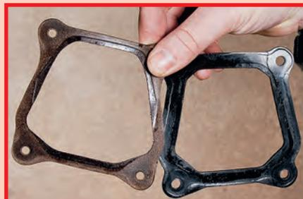
Прокладки клапанных крышек. У Pго (слева) она изготовлена из более качественного и дорогого материала
