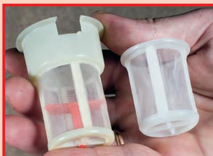
Сетчатые фильтры на горловине топливного бака. Слева — Pго, справа — LT. У Pго внутренний объём больше, проще заливать топливо, и сетка закреплена в пластиковой обойме более надёжно
