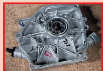
Боковая крышка двигателя с подшипником коленвала
