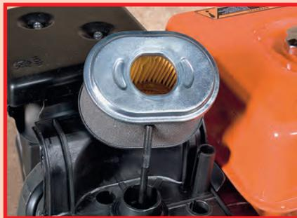
... а вот и отличия. У мотора из серии Pго пластиковое литьё более аккуратное, с меньшими зазорами, да ещё и резиновое уплотнительное кольцо заложено в буртик между двумя деталями. Значит, качество фильтрации воздуха у Pго выше, он работает в более благоприятных условиях — вот одна из предпосылок для большего моторесурса
