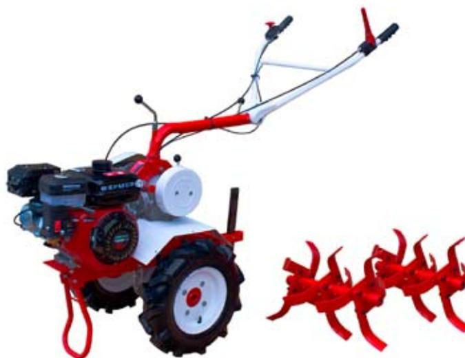
и воздушного фильтра). Воздушный фильтр, кстати, необычный — выполнен в виде масляной ванны с вставкой из поролон.
