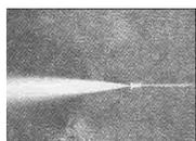
15° ЖЕЛТАЯ НАСАДКА. Данный наконечник делает угол распыления струи равным 15 градусам, для интенсивной чистки небольших поверхностей. Используйте эту насадку только для чистки поверхностей, способных выдержать высокое давление воды.
